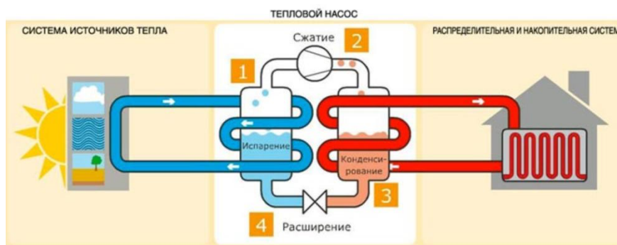
Рис. 1. Принцип работы теплового насоса
